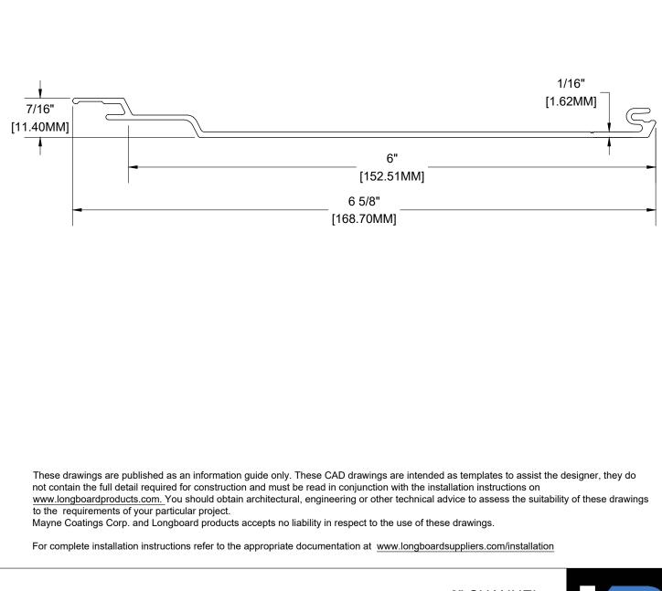
6" CHANNEL ALUMINUM ALLOY: 6063-T5 WEIGHT: 0.556 LBS/ LF SCALE: 1:1
