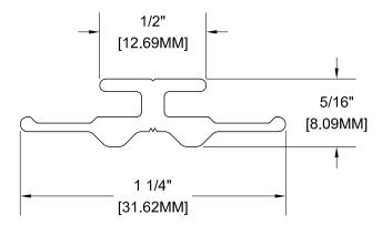
**TRADITIONAL BACK-TO-BACK** STARTER STRIP (1-1/4") ALUMINUM ALLOY: 6063-T5 WEIGHT: 0.161 LBS/ LF SCALE: 2:1
