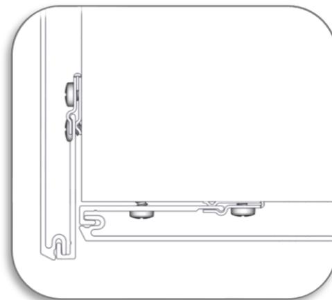
Remarque : Pour la condition de bord d'égouttement, la bande de départ nécessite deux ancrages à chaque point de fixation (un avec le clip Quick Screen et un dans le trou oblong supérieur).
